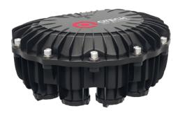
Данная дроп-муфта устанавливается на конечном каскаде сплиттирования при организации сети GPON в частном секторе. Емкость дроп-муфты позволяет осуществить подключение до 8 абонентов. Изделие поставляется в собранном виде (с установленным сплиттером по требованию заказчика 1x2, 1x4 или 1x8 и установленными съемными заглушками).
