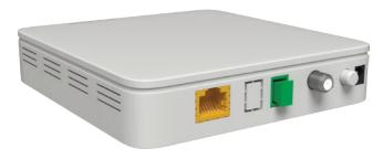
Высокоскоростные устройства доступа внутренней инсталляции, предназначенные для развертывания оптических сетей FTTH (Fiber To The Home), FTTO (Fiber To The Office), FTTB (Fiber To The Building). Устройства QONT-9-1G-C позволяют легко масштабировать оптическую сеть оператора и обеспечивают высокую скорость передачи - до 1000 Мбит/с до конечного абонента.
